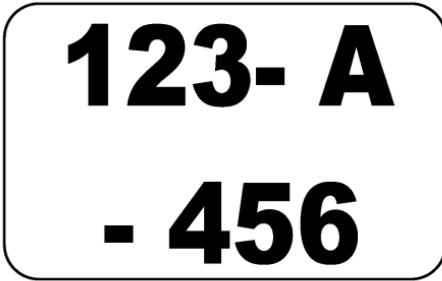
Izgled tablice, dimenzije 240 mm x 130 mm x 1 mm
